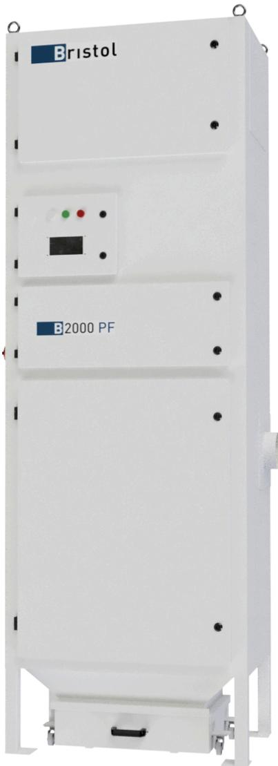
Für Luftvolumen von 600 bis 2000 m<sup>3</sup>/h setzen wir effiziente und kompakte Patronenfilter ein. Mit geringer Stellfläche sind sie äußerst platzsparend und durch die automatische Abreinigung der Filterpatronen sehr effizient. Für eine höhere Abscheideleistung bei extremer Partikelbelastung gibt es alle Filtergeräte optional auch mit hocheffizienter Kompaktfilterkassette oder Schwebstoff-Nachfilter.
