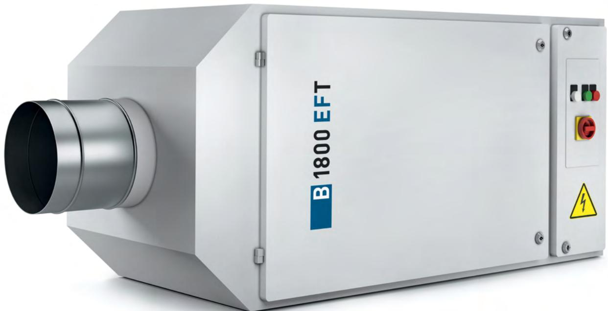
Der Einzelfilter B 1800 eignet sich für die energieeffiziente Abscheidung von Partikeln bis  $0,1 \mu\text{m}$ . Stufenlos regelbar ist er speziell für Öltrauch sowie Öl- und Emulsionsnebel für Luftvolumen bis  $1800 \text{ m}^3/\text{h}$  ausgelegt. Leistungsstark auf kleiner Stellfläche und einfach zu montieren. Als Tandem-Filter (siehe Abbildung) für hohen Abscheidegrad bei extremer Partikelbelastung.
